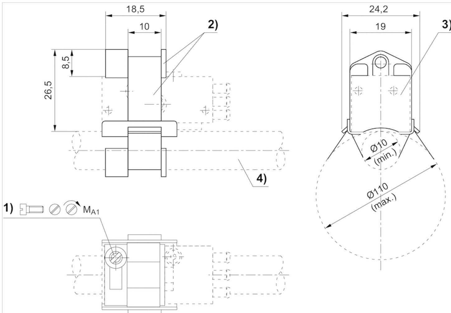
1) Klemmschraube 2) Spannband mit Halter 3) Sensor 4) Zylinderrohr
