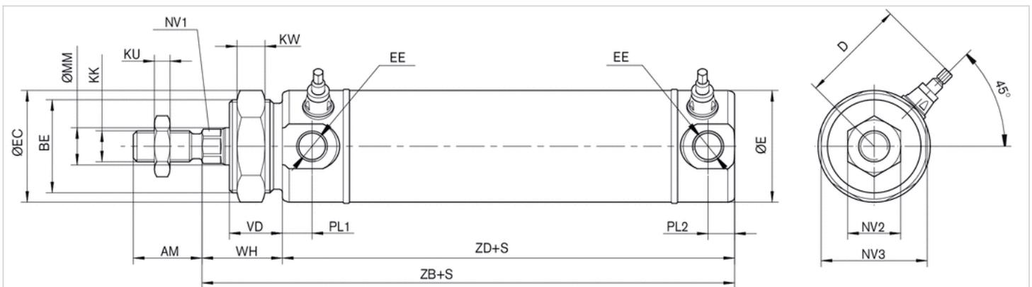
S = Hub, Toleranz Ø 32–50 mm = +2/-0, Ø 63–100 mm = +2,5/-0. Der Zylinder wird mit Kolbenstangenmutter gemäß ISO 4035, DIN 439 geliefert.
