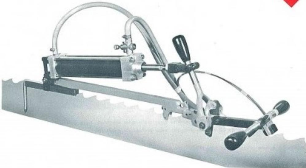
L'appareil à rectifier pneumatique **type RMP**, comme l'appareil manuel, est d'un réglage très simple.
